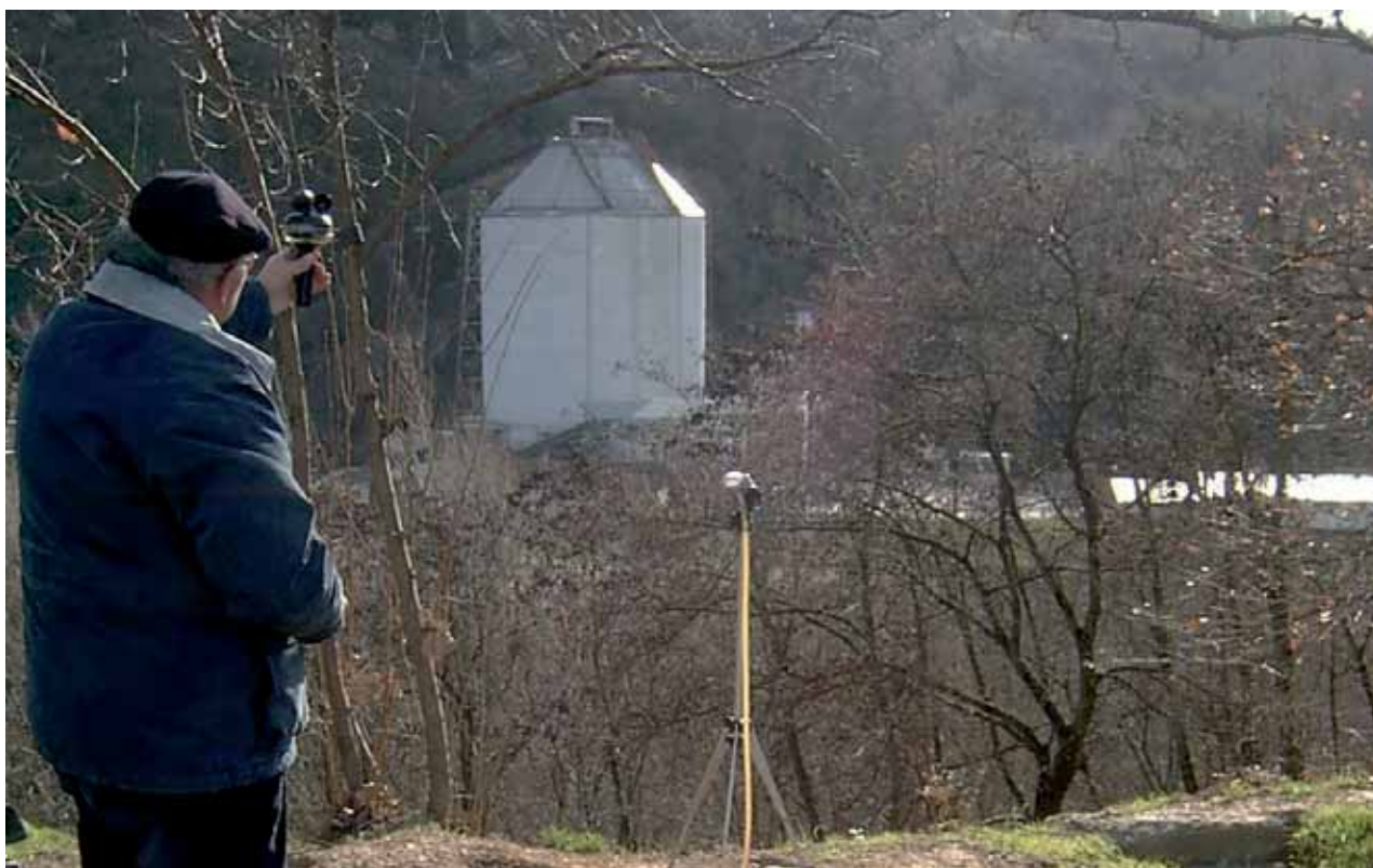
Fig. 16 – Monitoraggio delle polveri diffuse: sullo sfondo è visibile il piazzale di base e il silos (foto R. Margutti).
