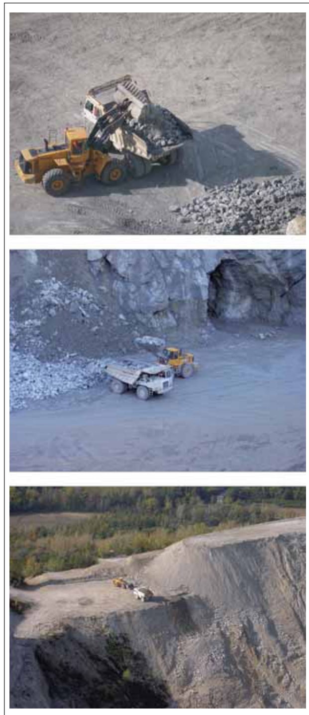
Fig. 13 – In alto e al centro: operazioni di smarino. In basso: sterile di coltivazione scaricato dai dumper nei pressi del ciglio della discarica mineraria (foto R. Margutti).
