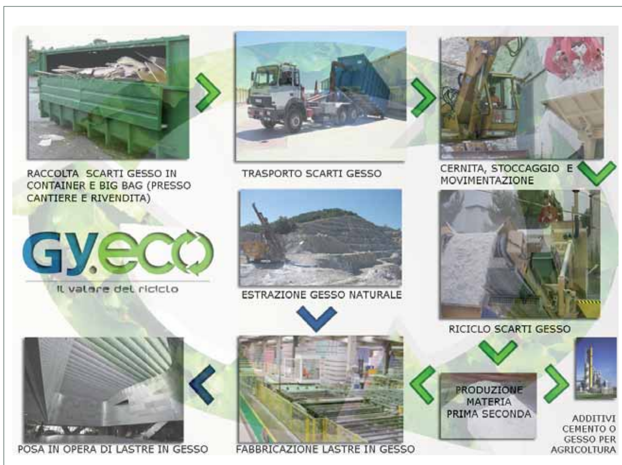
Fig. 28 – Sistema di gestione e recupero di scarti del progetto Gy.eco (Life Cycle; da www.gyeco.it ).
