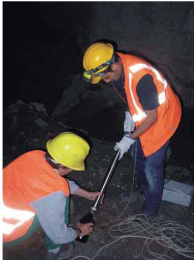
Fig. 16 – Fasi di campionamento con bailer in acciaio ( well sampler ) nel piezometro S2 ubicato nella galleria di quota 200 m s.l.m. (foto Archivio GYPROC Saint-Gobain).
