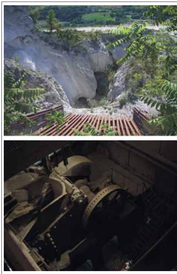
Fig. 15 – In alto: pozzo principale (via di gettito) accessibile a cielo aperto dalla quota di 260 m s.l.m. (foto R. Margutti). In basso: particolare del frantoio primario a mascelle (a doppia ginocchiera) con bocca 1200x1000 mm della Loro & Parisini (foto R. Margutti).
